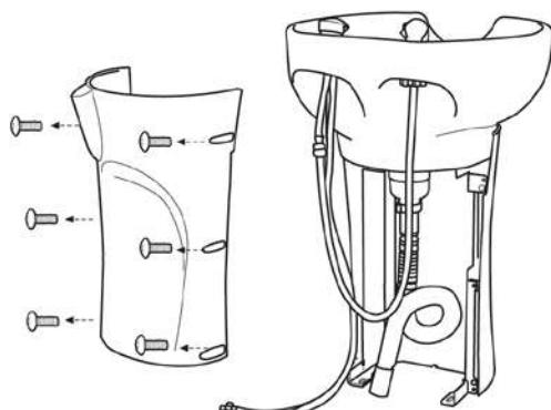
Отвинтите и снимите заднюю крышку стойки раковины.
