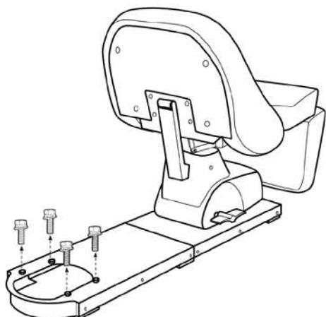
Выверните болты крепления стойки раковины.
