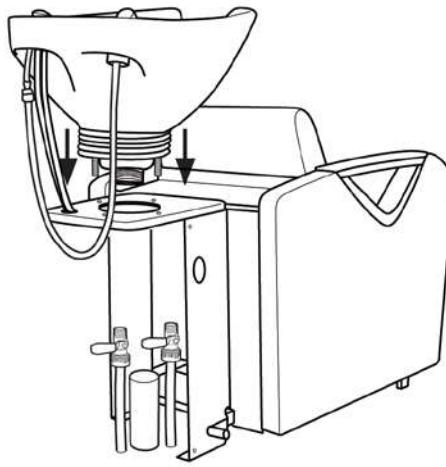
Отвинтите и снимите заднюю крышку стойки раковины.
