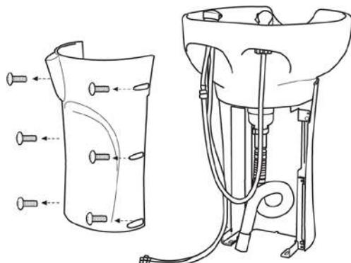
Отвинтите и снимите заднюю крышку стойки раковины.
