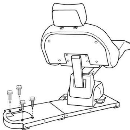
Выверните болты крепления стойки раковины.
